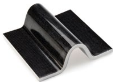
図 4 : マッチ金型によるサーモフォーミング
