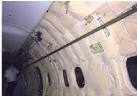
Thermisch- akoestische isolatiedekens Halar® ECTFE, KetaSpire PEEK of PEKK
