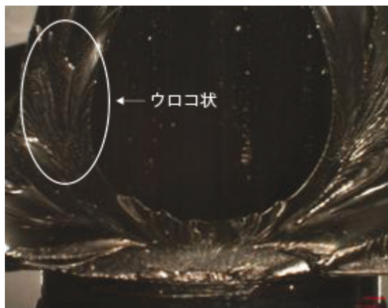
図4： 機械的破壊の後、伝播速度が増加したときのウロコ状のパターン
