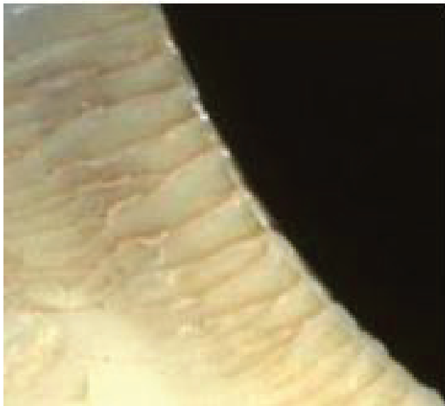
図 10：低倍率での同一成形品の破面。パターンは明らかに機械的破壊に関連する。
