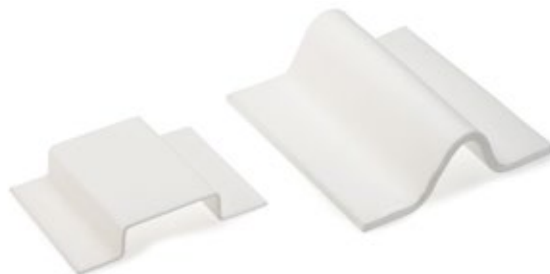
图3: PPSU泡沫可以热成型加工成带有曲线和转角形状
