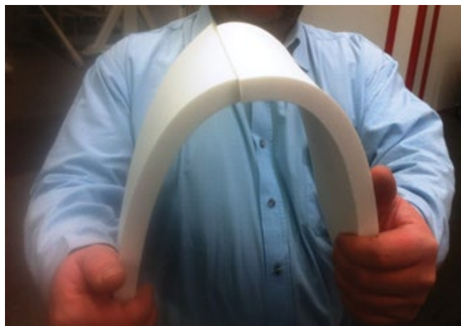
图9: R-1050 PPSU泡沫对焊强度
