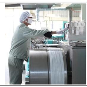
北京赛诺膜技术有限公司选用索尔维的 Solef® PVDF(聚偏氟乙烯)实现了其 TIPS 膜技术的优化。这种技术被用于工业和饮用水等行业的反渗透预处理。Solef® PVDF 的窄分子量分布以及更为均匀的容积密度使得赛诺可以生产出更为稳定的挤出材料,以优化其 TIPS 膜的性能和可靠性。
