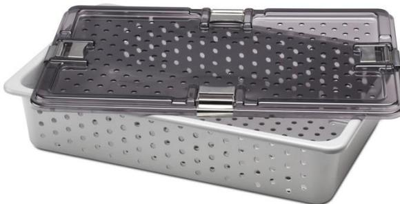
Legacy Medical Solutions 公司选用索尔维的 Radel® PPSU（聚苯砜）树脂制成带有金属夹紧装置的创新型消毒托盘。该托盘可适用于多种灭菌方式，包括在高达 138 ° C（280 ° F）的温度下进行长时间的高压蒸汽灭菌。Radel® PPSU 具有优异的耐化学性和抗冲击强度，可支持机械加工和热成型，有透明和不透明色可供选择。图片由索尔维提供。
