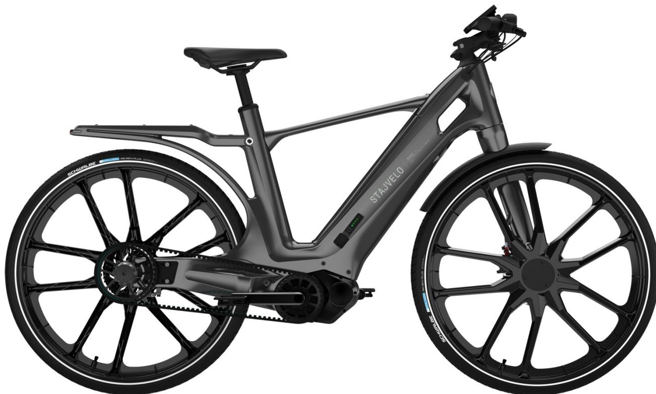
Stajvelo 生活方式自行车是新一代创新电动自行车，它兼具便捷、舒适性和设计感于一身，是首款采用索尔维先进注塑复合材料 Xencor™ LFT 制造的电动自行车。图片由 Stajvelo 提供。
