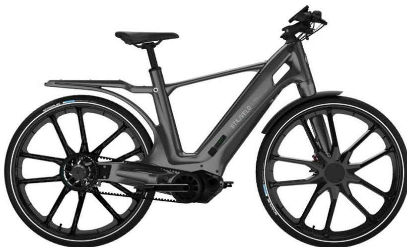
Stajvelo の Lifestyle Design Bike は、ソルベイの高機能射出複合材 Xencor™ LFT を採用し、可動性、快適性、デザイン性を兼ね備えた革新的な新世代の E バイクです。写真提供: Stajvelo 社
