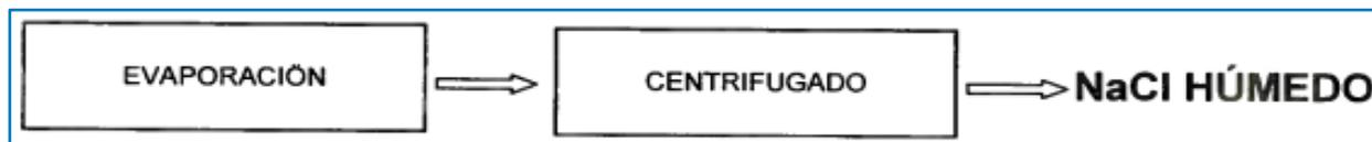
Esquema 4. Obtención Cloruro Sódico.
