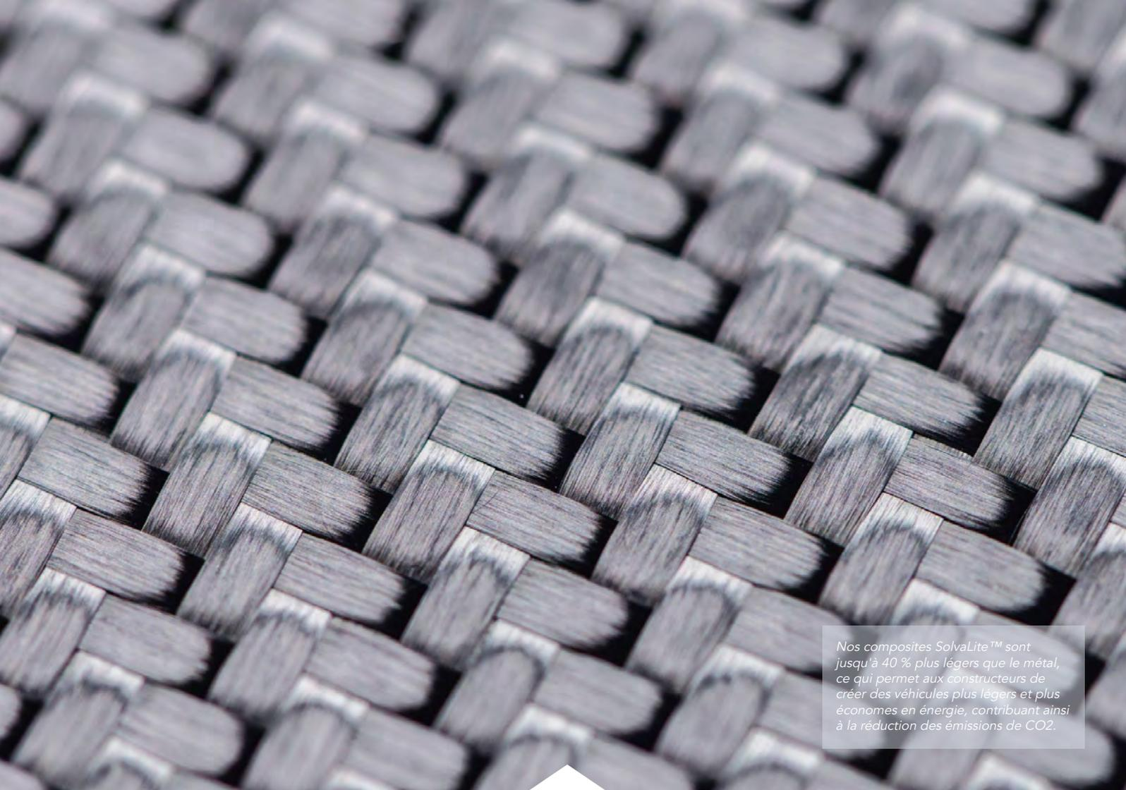
*Nos composites SolvaLite™ sont jusqu'à 40 % plus légers que le métal, ce qui permet aux constructeurs de créer des véhicules plus légers et plus économes en énergie, contribuant ainsi à la réduction des émissions de CO2.*
