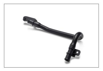
La nouvelle série d'extrusion PPS Ryton® de Solvay vise à compléter les matériaux éprouvés de moulage par injection PPS Ryton® destinés à être utilisés ensemble dans les applications exigeantes d'assemblage des lignes de refroidissement automobiles. La rigidité de ces grades oscille entre 1500 MPa (218 ksi) et 2500 MPa (363 ksi) pour satisfaire aux cahiers des charges des tubes flexibles avec différentes épaisseurs de paroi et différents diamètres, ou à des fins de thermoformage post-extrusion.
