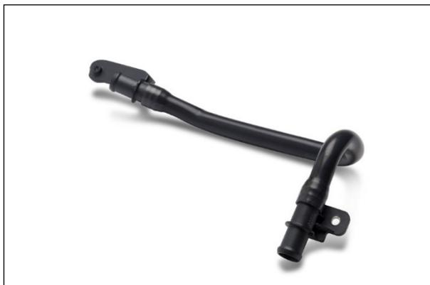
ソルベイの新しいライトン® PPS 押出し成形シリーズは、定評あるライトン® PPS 射出成形材料を補完し、要求の厳しい自動車冷却配管アセンブリの用途で併用されることを目的としています。これらのグレードの剛性は 1500~2500 MPa の範囲で異なり、さまざまな肉厚と直径を持つフレキシブルチューブの要件を満たすことができます。また、押出し成形後の熱成形にも適しています。写真および図提供: ソルベイ
