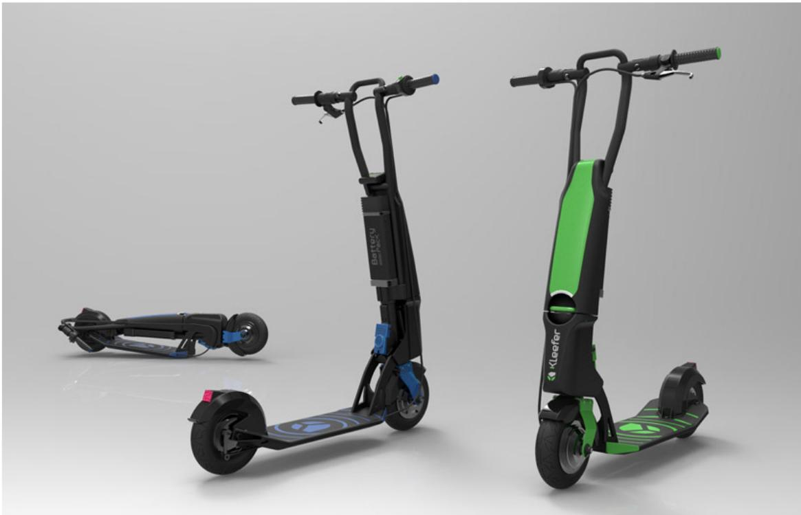
軽量折畳式「Bud-e」電気アーバンスクーターは、ソルベイ・エンジニアリング・プラスチックスのガラス充填 Sinterline™ Technyl® パウダー製のフェアリングを採用した Kleefeer 社の製品です。
