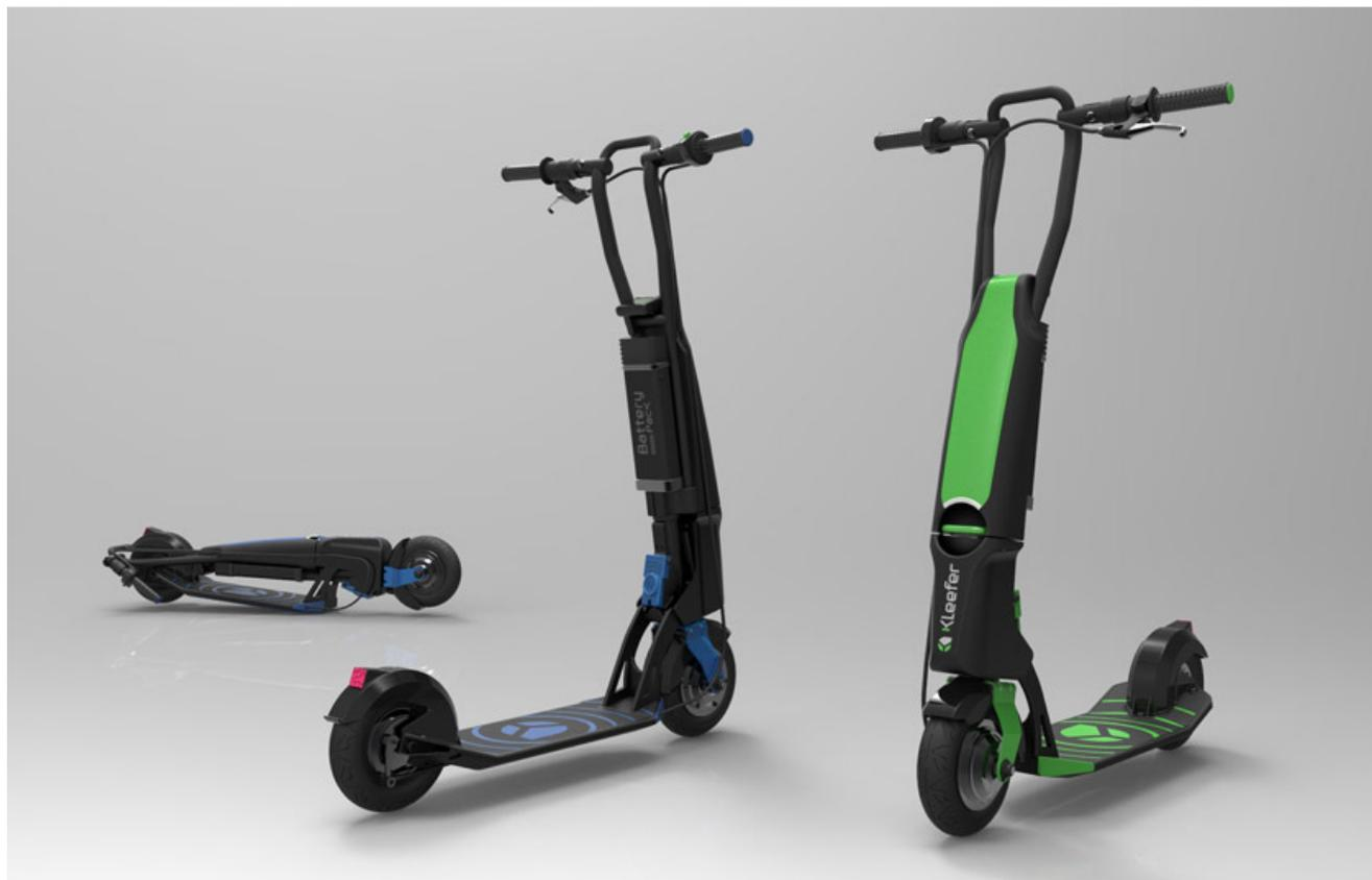
Patinete urbano elétrico "Bud-e" leve e dobrável fabricado com peças de carenagem utilizando pó Sinterline™ Technyl® preenchido com vidro da Solvay Engineering Plastics.
