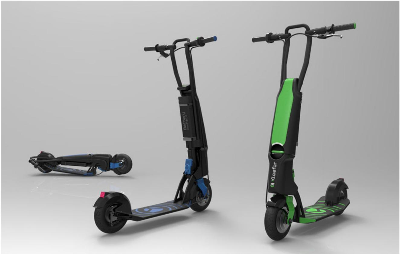
*Bud-e el patín urbano eléctrico plegable y ligero de Kleefer, el cual tiene partes de la carcasa reforzadas con fibra de vidrio Sinterline™ Technyl® en polvo.*
