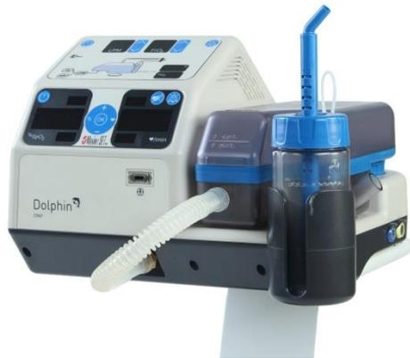
索尔维的可消毒型 Udel® P-1700 聚砜帮助越南河内的 MTTs 有限公司开发出创新型海豚气泡式 CPCA（持续正压呼吸）设备。该设备结合了最新的呼吸道护理技术，给患者带来了特别的价值。CPAP 疗法，即持续正压气道通气法，可以帮助那些能够自主呼吸，但往往呼吸不足的早产儿和低出生体重新生儿保持气道开放从而顺畅呼吸。索尔维的 Udel® P-1700 聚砜作为一次性聚合物部件的可消毒替代产品，用于成为机器的两个半透明组件，如图 MTTs 设备右侧所示。从左侧：加湿器外壳和系统呼气末正压（PEEP）通气腔。
