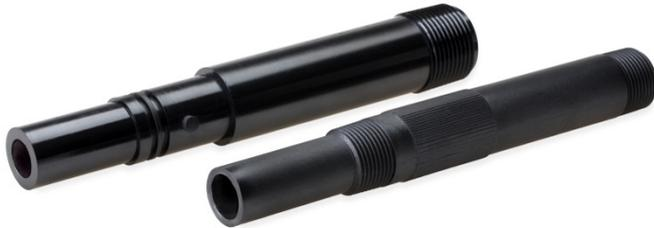
Advanced Sensor Technologies (ASTi) 社は、工業プロセスでの pH または酸化還元電位 (ORP) 評価用に設計された、2 種類の高性能工業用センサーにおけるハウジング成形用に、ソルベイのライトン® ポリフェニレンスルフィド (PPS) 樹脂を選択しました。ASTi 社が導入したのはライトン® R-4-230BL です。これは、高温の環境下でも優れた加工性と強固な剛性、高い耐薬品性が維持される、40% ガラス繊維強化 PPS コンパウンドです。写真提供: ソルベイ
