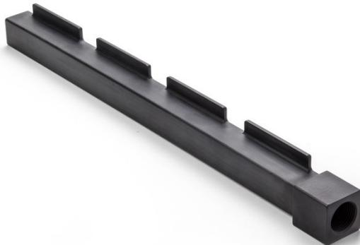
Polimotor 2 汽车发动机项目选用索尔维高性能等级 KetaSpire® KT-820 CF30 聚醚醚酮 (PEEK) 材料，用于生产发动机干式油底壳组合式油泵系统回油器管。这种 30% 碳纤增强的聚醚醚酮等级材料在长期使用温度高达 240°C (464°F) 时，依然保持高模量和顶尖的抗疲劳性能。更重要的是，其尺寸稳定性高，可以防止部件在机加工过程中弯曲。
