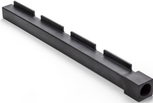
自動車エンジンプロジェクト Polimotor 2 で用いられるドライサンプ式モジュラー型オイルポンプシステムのオイル除去ラインの製造材料として、ソルベイのキータスパイア® KT-820 CF30 ポリエーテルエーテルケトン (PEEK) の高機能グレードが選ばれました。この 30%炭素繊維強化グレードは、高い弾性率と比類なき耐疲労性を備え、240°Cに達する温度環境での連続使用にも耐えられます。さらに特筆すべきは、高い寸法安定性により、切削加工中の部品のポーイングを防止できる点です。
