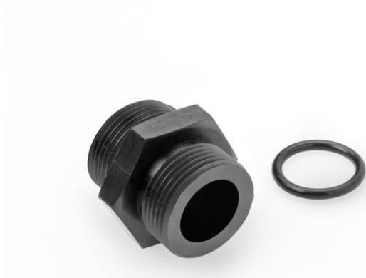
Polimotor 2 プロジェクトは、最先端レース用エンジンのウォーターインレット／アウトレット設備の材料として、ソルベイスペシャルティポリマーズのアモデル® A-8930 HS ポリフタルアミド (PPA) を選択しました。ソルベイの高機能強化グレード PPA は、高温になる自動車のエンジンクーラントでの耐性がポリアミド 66 よりも優れています。また、自動車メーカーがエンジン設備の温度上昇に対処する際、自動車冷却システム部品の設計上の選択肢も広がります。写真提供：ソルベイスペシャルティポリマーズ
