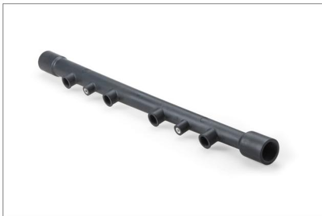
El proyecto de motor solo de plástico Polimotor 2 ha seleccionado la resina reforzada de poli(sulfuro de fenileno) (PPS) Ryton® XK2340 de Solvay para moldear por inyección su riel de inyectores de 46 cm (18 pulgadas). Sustituir el componente habitual de acero por un termoplástico de altas prestaciones no solo permitía moldear por inyección el riel de inyectores en una sola pieza, sino también reducir su peso entre un 25 y un 30 por ciento.
