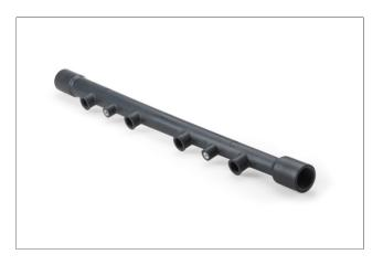
Le projet de moteur tout en plastique Polimotor 2 a choisi la résine renforcée de polyphénylsulfone (PPS) Ryton® XK2340 de Solvay pour le moulage par injection de la rampe d'alimentation de carburant de 46 cm. Le remplacement de l'acier par un thermoplastique hautes performances a permis non seulement le moulage de la rampe de carburant en une seule pièce, mais aussi un allègement de 25 à 30% de cet élément.
