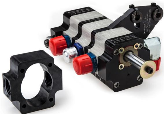
索尔维的 AvaSpire® AV-651 CF30 聚芳醚酮 ( PAEK ) 将被用于打造 Polimotor 2 引擎独特的干式油底壳模块化油泵外部壳体及其它三个部件。AvaSpire® AV-651 CF30 PAEK 是一种 30% 碳纤增强型配混料，强度、刚度和抗疲劳性实现了最佳平衡。非常适合制造 Polimotor 2 油泵壳体。可承受接近 140°C ( 284°F ) 的油温及在 2.8 至 5.5 巴的内部循环压力。
