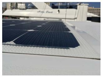
由 Amcor 公司利用索尔维 Halar® 500 ECTFE 树脂挤出加工而成的高透明太阳能电池(PV)面板,使得 SolbianEnergie Alternative 公司开发出可以直接集成在船只甲板内的创新型太阳能电池板。索尔维轻质、耐用型 ECTFE 树脂,让Amcor 的面板具有高透明、不打滑的纹理,可耐受严酷的海洋环境和频繁的人员穿行踩踏。图片由 SolbianEnergie Alternative 提供。
