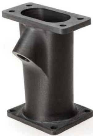
Kraftstoffansaugrohr für den Vollkunststoffmotor Polimotor 2, hergestellt in einem Fusionsverfahren für verstärkte Filamente (FFF) aus 10 % glasfaserverstärktem KetaSpire® PEEK-Polymer von Solvay (Bild Solvay)
