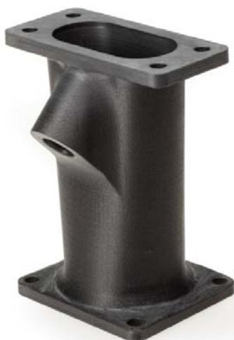
Polimotor 2 オールプラスチック製エンジンの燃料インター クランナー。10%ガラス充填キータスパイア® PEEK ポリ マーを用いて、強化材フィラメント熱溶解技術で 3D プリント により製造。(写真提供:ソルベイ)
