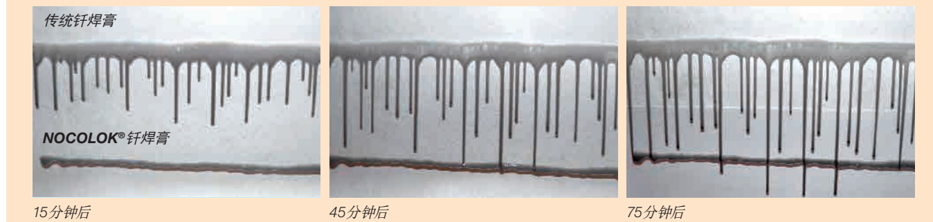
上方为传统钎焊膏下方为 NOCOLOK® 钎焊膏
