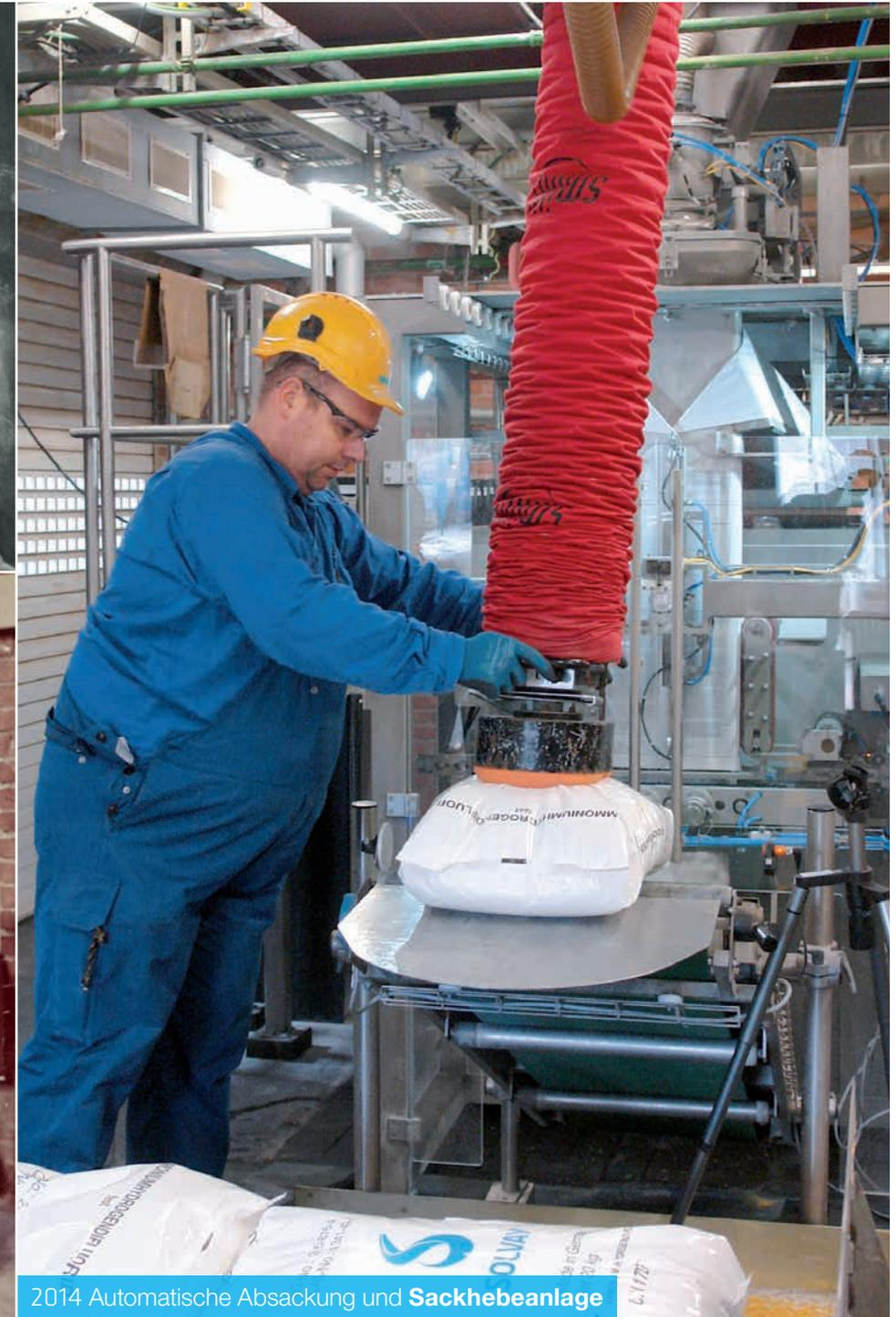
2014 Automatische Absackung und **Sackhebeanlage**
