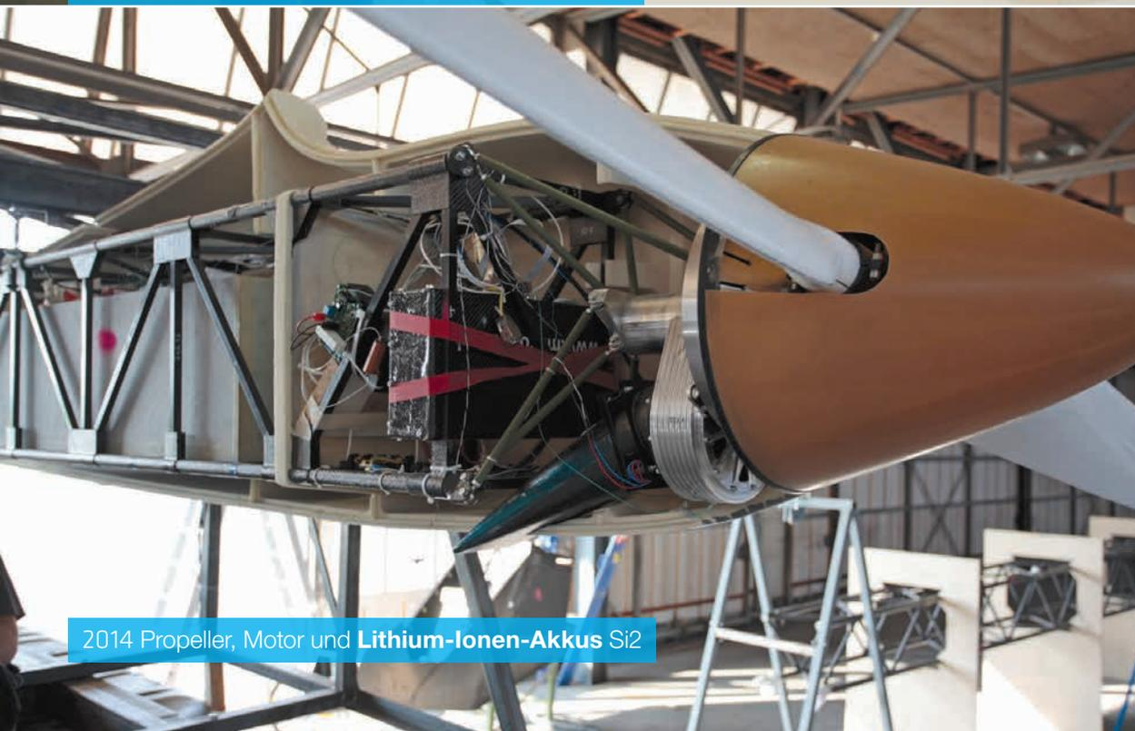
2014 Propeller, Motor und **Lithium-Ionen-Akkus** Si2
