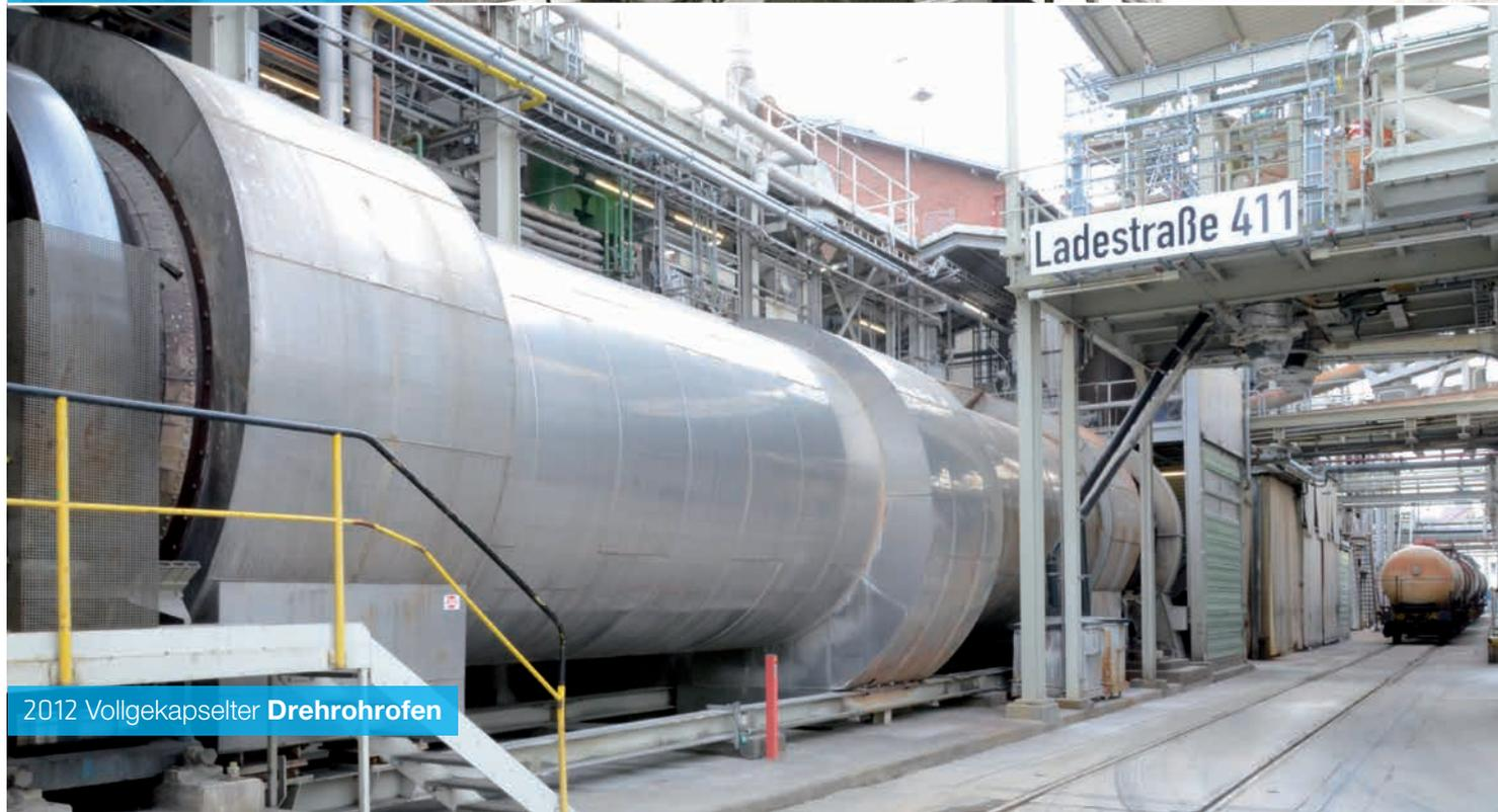
2012 Vollgekapselter **Drehrohrofen**
