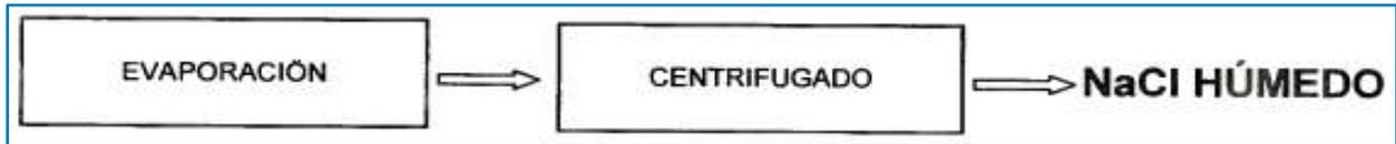
Esquema 4. Obtención Cloruro Sódico.
