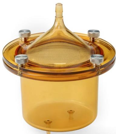
Le polyphénylsulfone (PPSU) Radel® R-5000 biocompatible, tenace et transparent de Solvay remplace le polyétherimide comme matériau de choix de Biorep Technologies pour sa nouvelle chambre de Ricordi, servant lors des greffes cliniques à isoler les cellules saines du tissu pancréatique.
