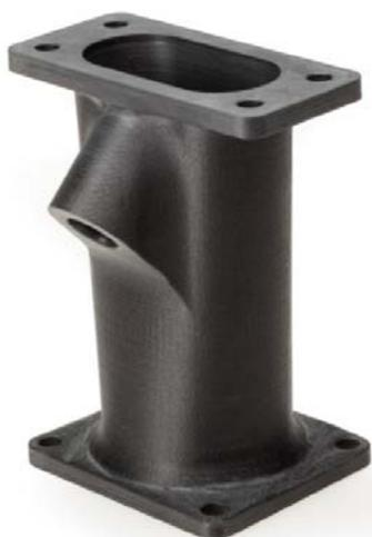
Polimotor 2 全塑发动机的进油管流道，用 10% 玻纤填充 KetaSpire® PEEK 聚合物，经增强熔丝制造工艺 3D 打印而成 ( 图片由索尔维提供 )。
